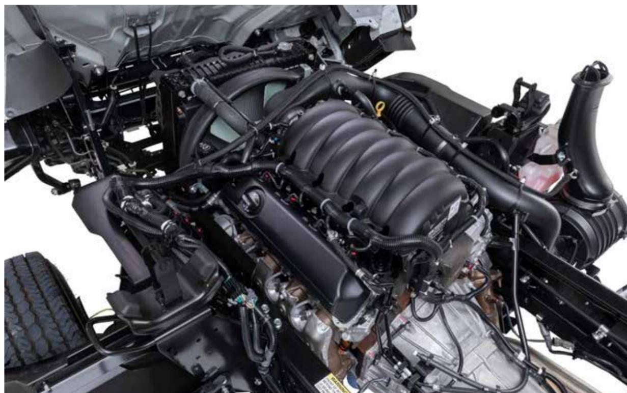
Le dur travail des camions poids moyen requiert un groupe motopropulseur durable. La Série N répond à ce besoin avec son bloc-moteur en fonte spécialement conçu pour les usages intensifs. De plus, les plus gros jets de refroidissement des pistons réduisent la température du moteur pour l'aider à rester plus frais et plus efficient.
